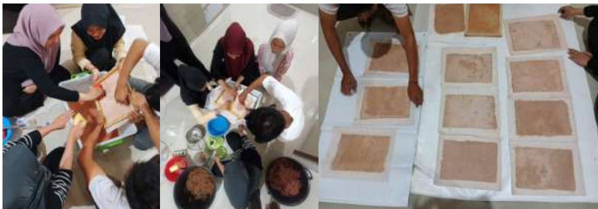
Gambar 5. Proses pencetakan pulp ke dalam cetakan kertas, pengaturan ketebalan,, penirisan, dan pengeringan.
